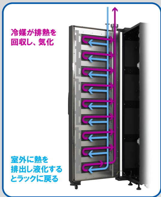
相変化冷却ユニット + Micro Modular Server
